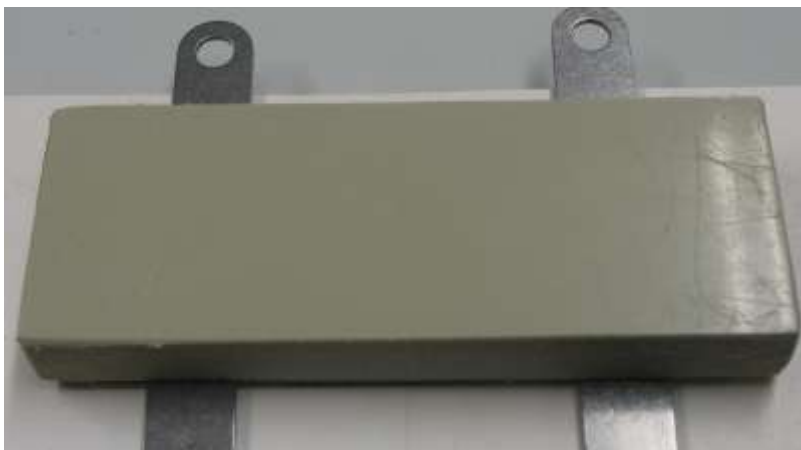
Abb. 5: Kammer mit PVC-Block abdichten und einstellen
